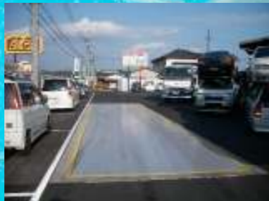
50t トラックスケール
